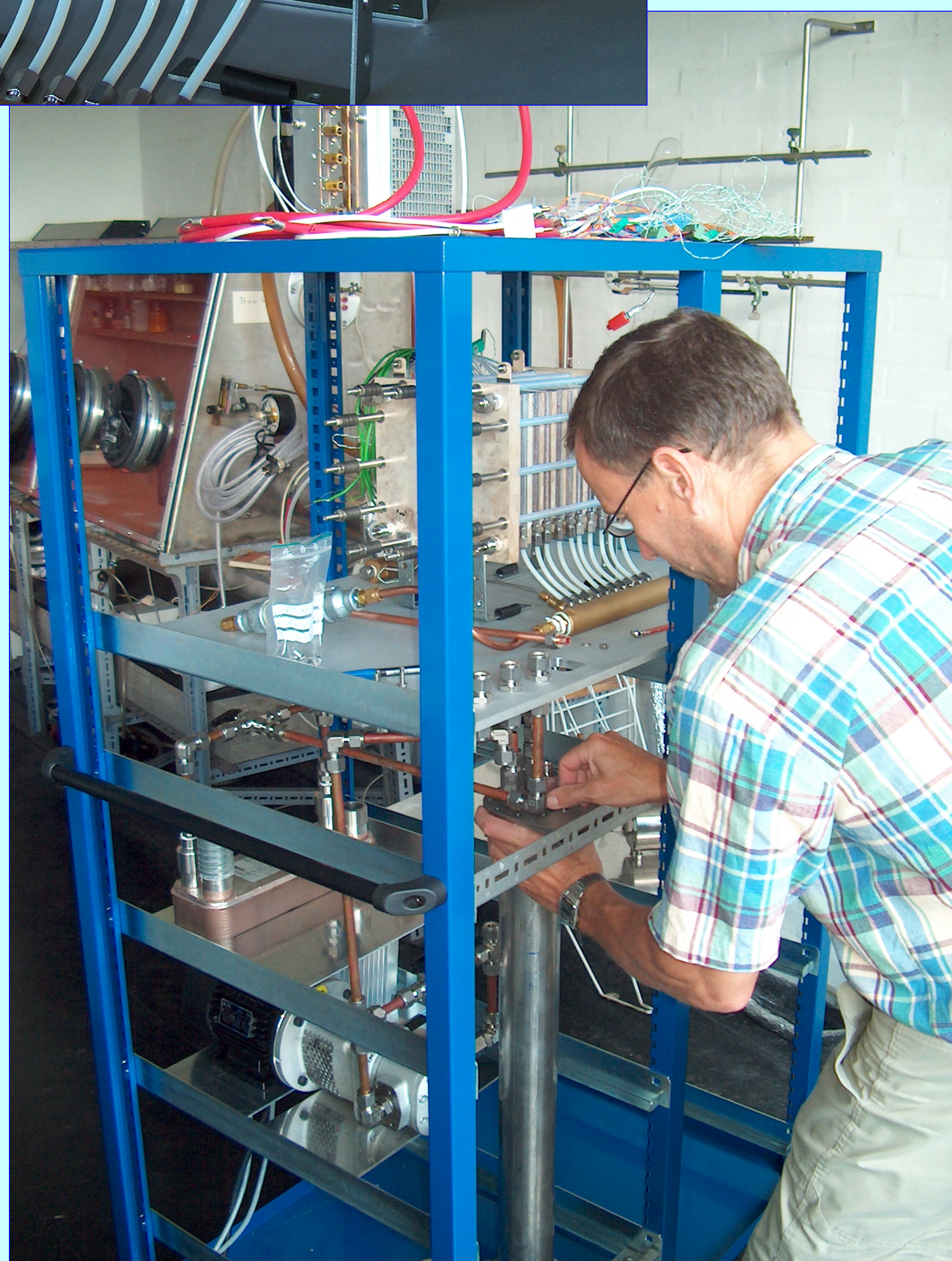
Teststation under konstruktion til stakke ved 200°C med olieklølig
